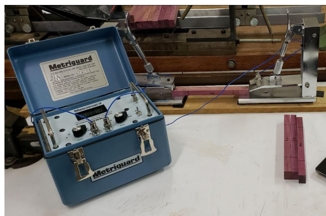
Figura 1 – Equipamento stress wave timer empregado na captação da velocidade de propagação sonora, das amostras de madeira.
