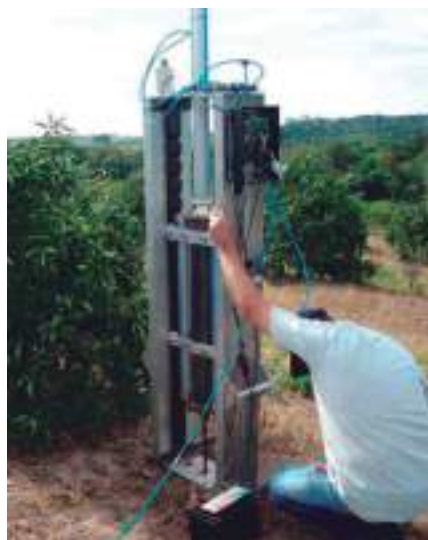
Figura 13 – Equipamento mede resistência à penetração e permeabilidade do solo
